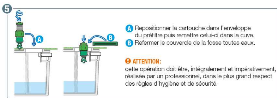
Figure 3 :Exemple du nettoyage du Préfiltre EFT-080
